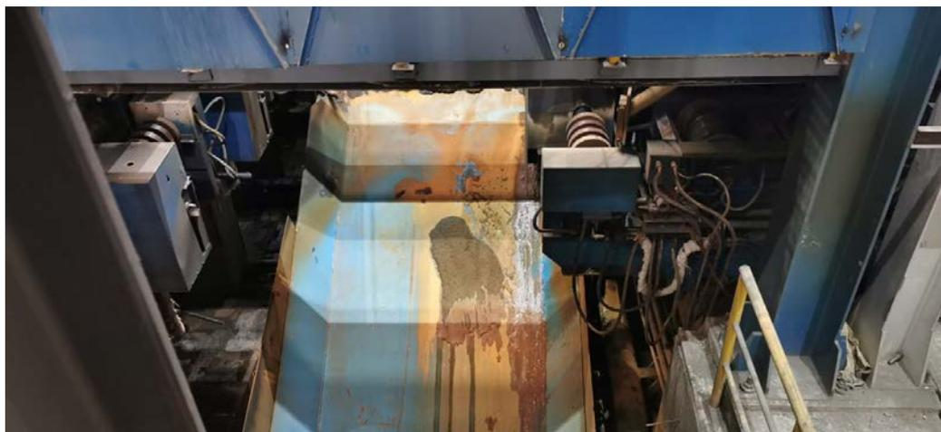
铸坯切头切尾、氧化铁皮、不合格铸坯堆放处
